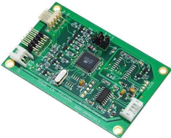
Anwendungsbeispiel: 8-MHz-Quarz (IC21) im HC-49-Gehäuse auf einem Controllerboard für resistive Touchsensoren
